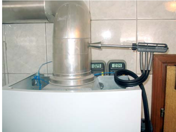
Ilustracija 1 Mjerenje temperature i sastava dimnih plinova uređajem Testo 325M
